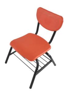
**Estructura:** Se fabrica totalmente con perfil de acero tubular redondo de 1" (25.4 mm.), en calibre 18, con las siguientes dimensiones: altura total 710 mm.; altura del asiento al piso 400 mm.; altura del piso a la parte inferior de la parrilla porta útiles 190 mm.; abertura lateral exterior de las patas 500 mm.; abertura frontal exterior de las patas 460 mm.
