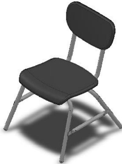
**ESTRUCTURA.** SE FABRICA TOTALMENTE CON PERFIL DE ACERO TUBULAR REDONDO DE 1" (25.4 MM) EN CALIBRE 18, CON LAS SIGUIENTES DIMENSIONES: ALTURA TOTAL 800 MM, INCLUYENDO REGATÓN; ALTURA DEL ASIENTO AL PISO 450MM, ALTURA DEL PISO A LA PARTE SUPERIOR DEL REFUERZO 195 MM, ABERTURA LATERAL EXTERIOR DE LAS PATAS 550 MM ABERTURA FRONTAL EXTERIOR DE LAS PATAS 530 MM.
