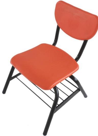
**ESTRUCTURA.** Se fabrica totalmente con perfil de acero tubular redondo de 1" (25.4 mm) en calibre 18, con las siguientes dimensiones: altura total 660 mm; altura del asiento al piso 360 mm; altura del piso a la parte superior del refuerzo 160 mm; la altura lateral y frontal exterior de las patas será de 460 mm.
