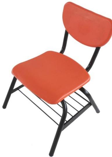
**Estructura:** Se fabrica totalmente con perfil de acero tubular redondo de 1" (25.4 mm.), en calibre 18, con las siguientes dimensiones: altura total 710 mm.; altura del asiento al piso 400 mm.; altura del piso a la parte inferior de la parrilla portaútiles 190 mm.; abertura lateral exterior de las patas 500 mm.; abertura frontal exterior de las patas 460 mm.
