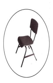
ESTRUCTURA: SE FABRICA TOTALMENTE CON PERFIL DE ACERO TUBULAR REDONDO DE 1" (25.4 MM.), EN CALIBRE 18, CON LAS SIGUIENTES DIMENSIONES: ALTURA TOTAL 810 MM.; ALTURA DEL ASIENTO AL PISO 450 MM.; ALTURA DEL PISO A LA PARTE INFERIOR DE LA SOLERA DE REFUERZO 150 MM.; ABERTURA LATERAL EXTERIOR DE LAS PATAS 540 MM.; ABERTURA FRONTAL EXTERIOR DE LAS PATAS 540 MM.
